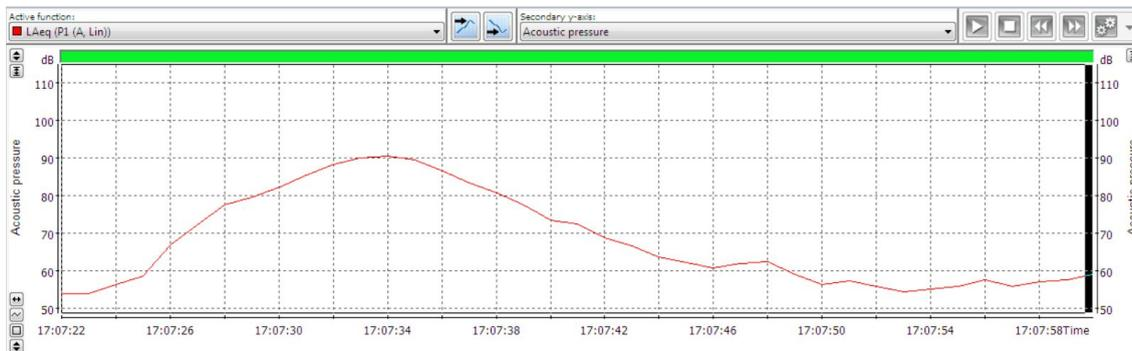
*Figura 1: Registro temporal (logger) de los niveles sonoros durante el despegue de un avión Boeing 737-800 de la empresa Flybondi, captado desde el patio del Colegio Emaús.*
